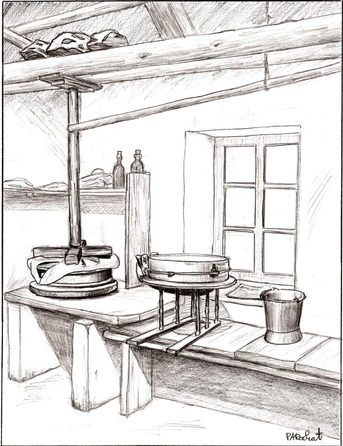
L'entrochoir du Pré d'Etoy et son système complexe de presse.
