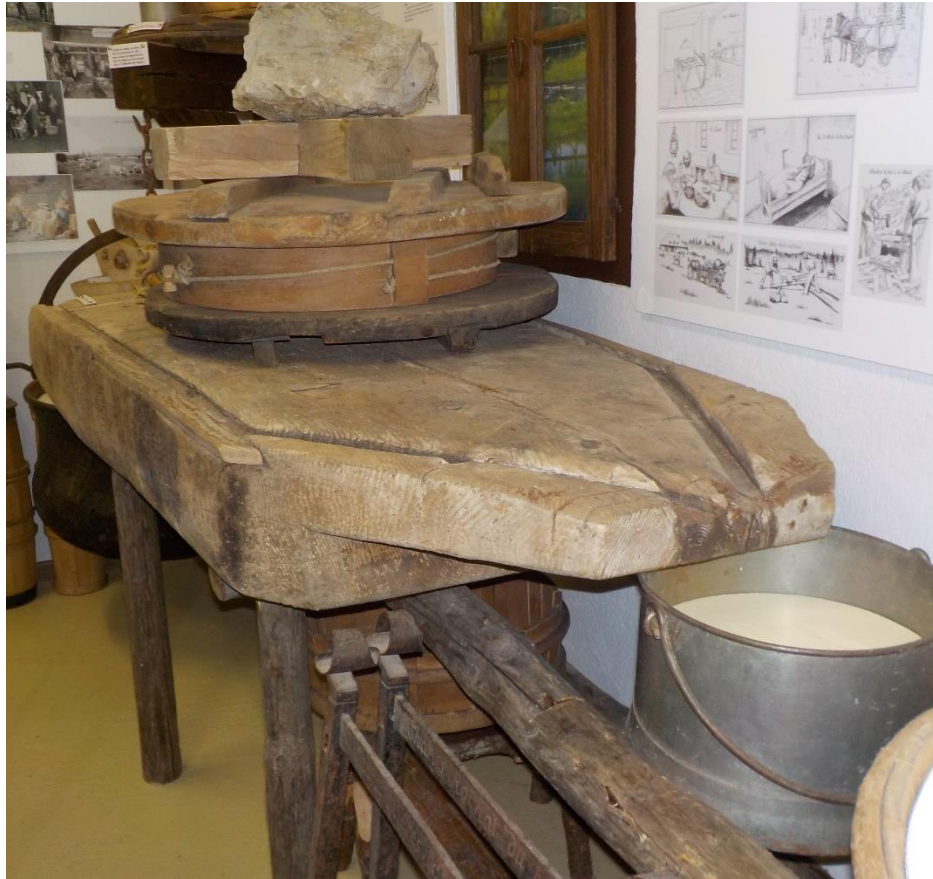
Un « enrochoir » d'antiques générations, sans doute le plus ancien de la Vallée, taillé directement dans un tronç d'arbre. Reconstitution.
