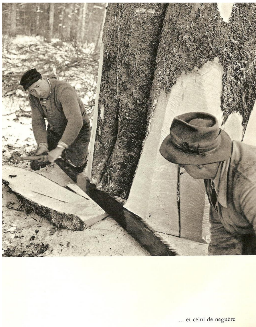
L'abattage à la louve ou au passe-partout. On parle aussi parfois de grande scie.
