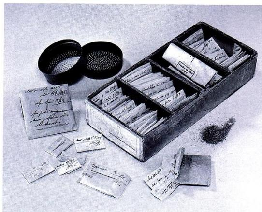
Figure 57. Bâtons ou «stocks» de lapidaire, sur lesquels les pierres à travailler étaient collées à la cire, puis polies au tour (voir figure de couverture). Tamis, sachet de pierres du pierriste (à droite). Long. du bâton de lapidaire avec la pierre: 12,5 cm; long. de la boîte de pierriste: 26 cm.
