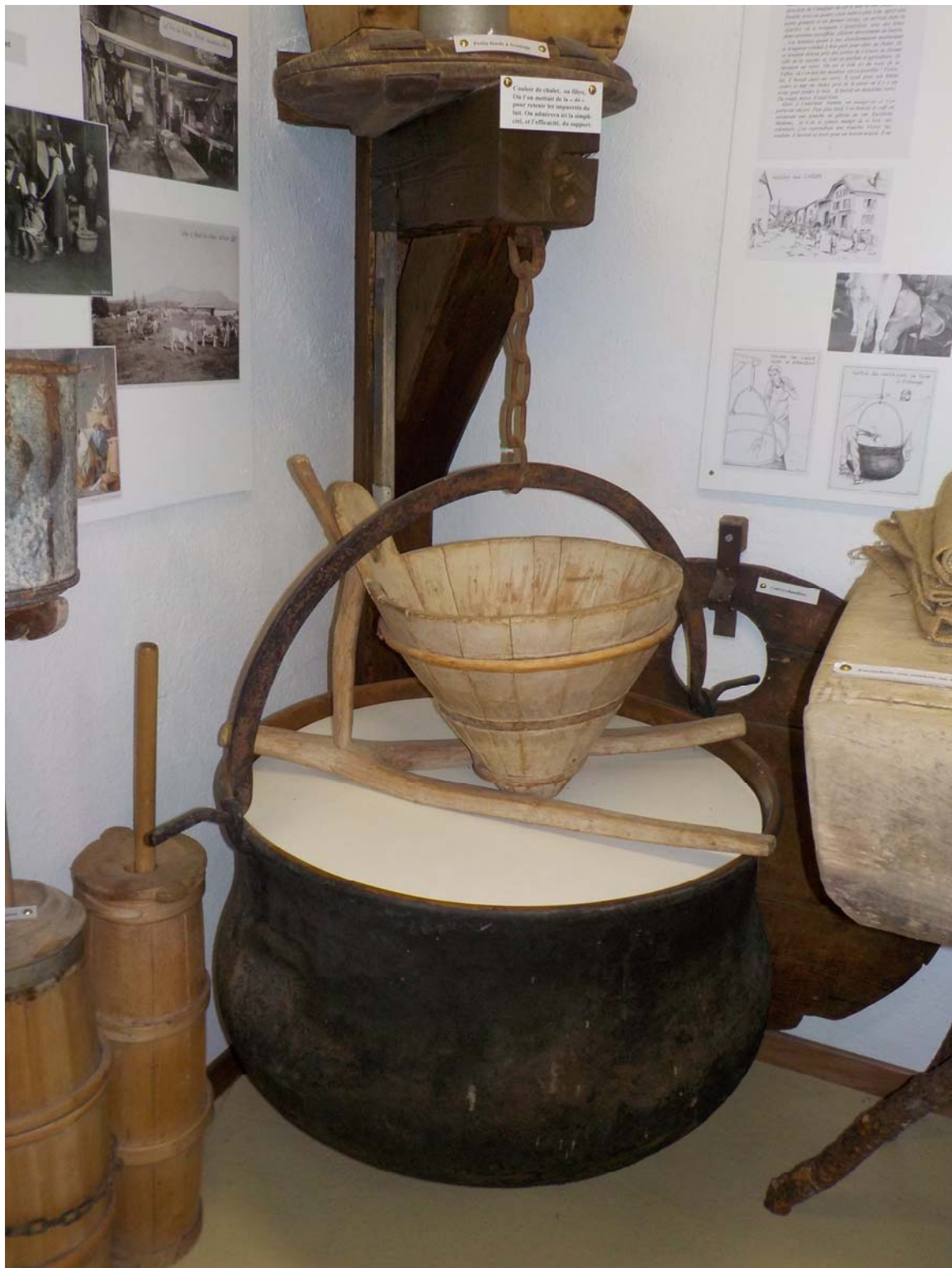
Filtre au-dessus de la chaudière de la collection Musée des glaciers et de l'alpage aux Charbonnières. La fabrication des couloirs était quasiment identique à celle des seillon, simplement que l'objet était plus conique afin que l'on puisse verser le lait plus facilement, et que naturellement il n'y avait pas de fond.
