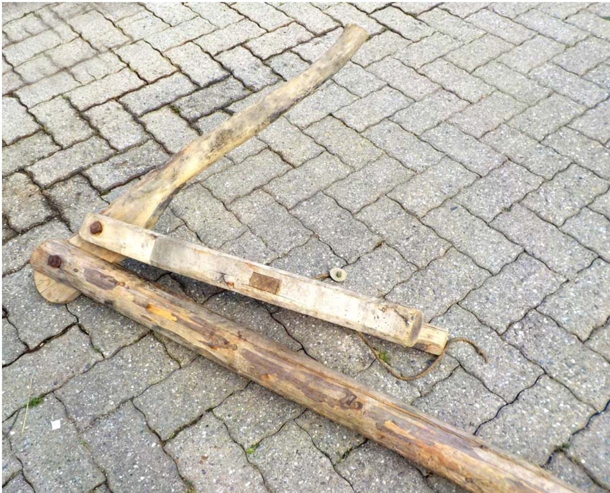
Cric de char. Il fallait vraiment des costauds pour le manier. Aucun cran d'arrêt, on relâche la grand barre d'appui, tout redescend.
