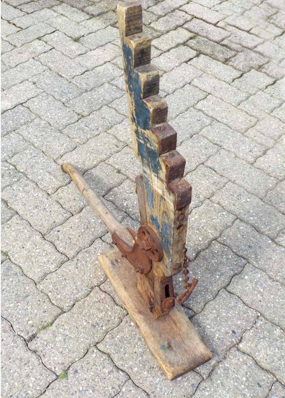
Cric de campagne. On glisse l'engin sous la pièce à soulever, le positionnement de l'une des encoches en fonction de la hauteur où l'on peut prendre appui.
