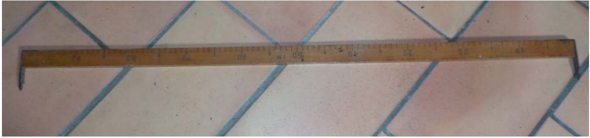
La mesure de 1 mètre, indispensable pour déterminer la longueur des troncs abattus.
