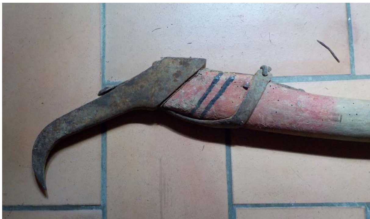
Le scherpi, pour manier les troncs, plutôt l'outil du débardeur que celui du bûcheron.
