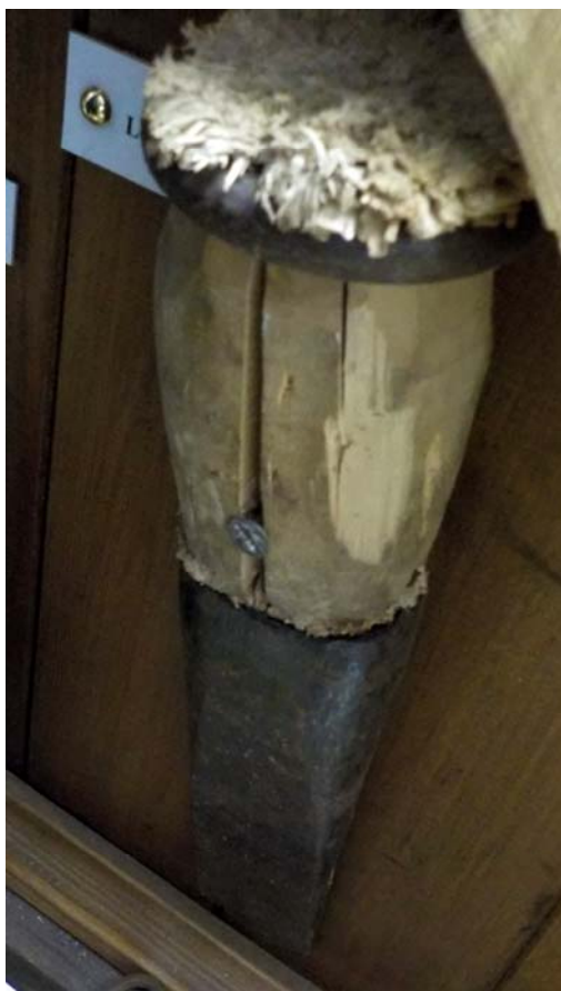
Le coin, mi-métal mi bois, avec la boucle pour empêcher l'éclatement. D'autres sont entièrement en métal, et d'autres encore, plus modernes, sont en alu.
