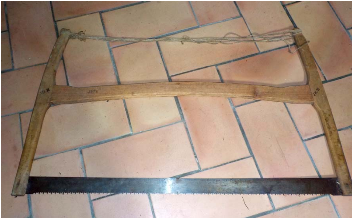
La grande scie à cadre était aussi utilisée en forêt. On l'a vu sur les photos précédentes.
