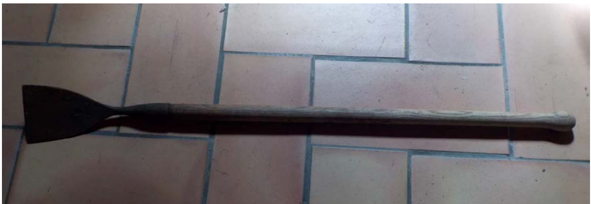
Le plumet, pour l'écorçage, d'une introduction relativement récente.
