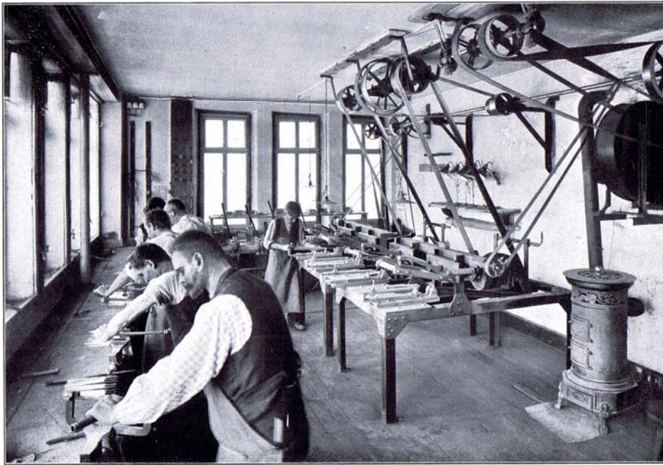
Fig. 10. — Atelier du limage. Rectification du meulage par limage à la main ou à la machine.
