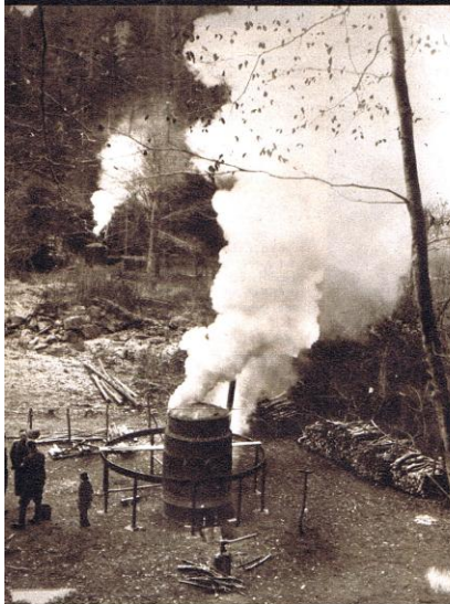
La carbonisation du bois. Les fumées qui jouent dans les ramures des hêtres, sont tour à tour blanches, puis jaunâtres, puis brunes, puis bleues quand l'opération est terminée.
