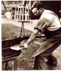
Première ébauche de la sonnette. Le fabricant taille dans la tôle, avec une cisaille à bras, les coupons correspondant à une moitié de sonnette.
