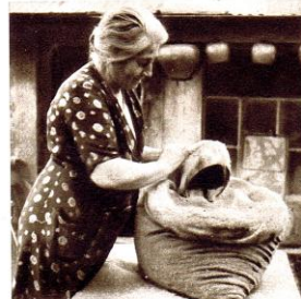
Dernier tour de main : décapage et nettoyage à la sciure de bois.
