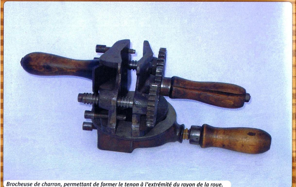
*Brocheuse de charron, permettant de former le tenon à l'extrémité du rayon de la roue.*
