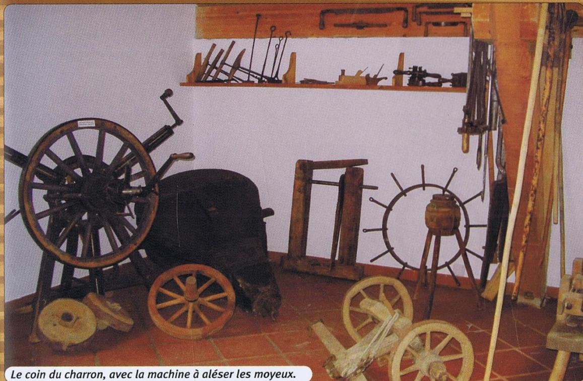
*Le coin du charron, avec la machine à aléser les moyeux.*
