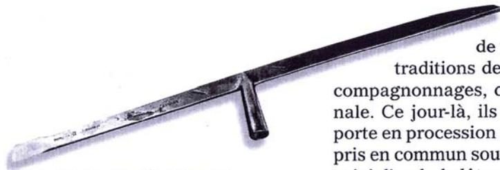
*La bisaiguë, l'instrument emblématique du charpentier, est une longue lame à deux taillants, ciseau et bédane. Cet outil sert à façonner les tenons et les mortaises.*
