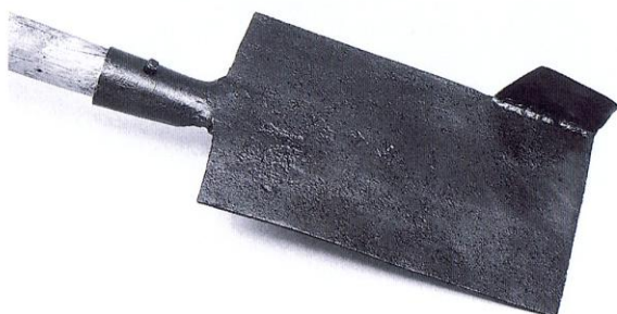
Figure 22. Louchet à tourbe. Sorte de pelle à couteau latéral pour débiter la masse en briques régulières. Long. totale: 130 cm, long. du fer: 36 cm. A droite, ouvrier tourbier, d'après une ancienne carte postale.
