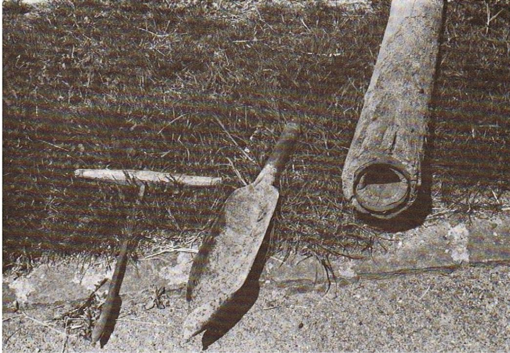
Extrémité du terâlon. Peut-être certaines de ces « mèches » pouvaient se fixer au bout de la tige, de telle manière qu'on pouvait les enlever pour un aiguisage plus aisé. On aperçoit la « boîte », voir ci-dessous, dans l'extrémité du tuyau de bois.
