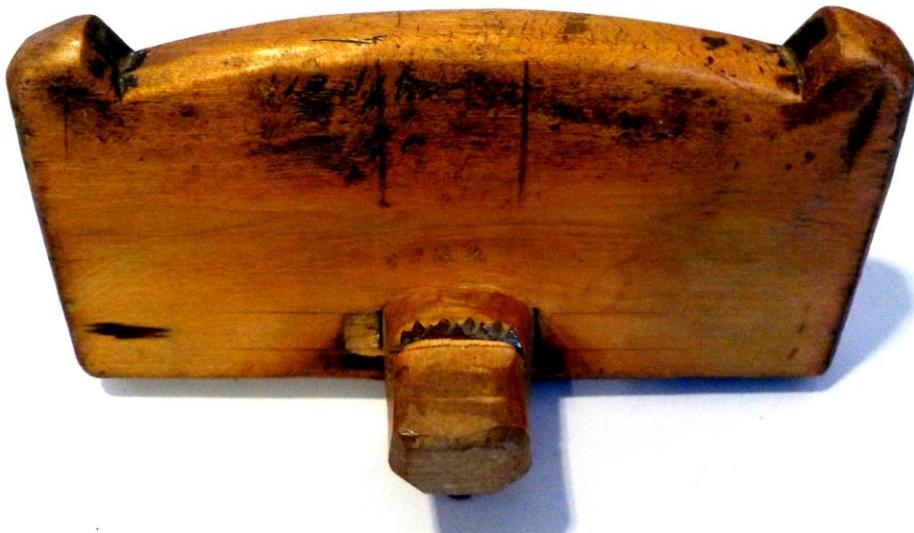
**MCCP9** : grand perçoir (terâlon en ancien langage) à tuyaux, avec le bois de protection mas par contre avec l'absence du guide qui se met dans le trou de l'extrémité du fer, côté personne. Longueur 2.40 m environ
