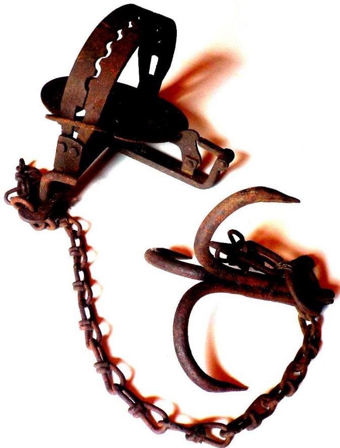
Ici l'intérêt réside non seulement dans le piège lui-même, relativement classique, avec néanmoins des dents assez peu acérées, mais aussi dans l'espèce d'ancre qui permet de fixer le piège au sol, et surtout d'empêcher que la bête ne parte avec tout « l'attirail » pour aller se perdre en forêt. En supposant même que l'ancre se soit détachée du sol où on l'a plantée, la victime ne pourrait aller bien loin avec l'encombrement de cette pièce supplémentaire.
