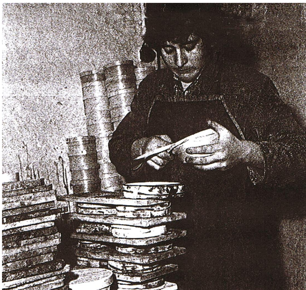
Le haut de la boîte est coupé au couteau pour adapter l'emballage aux dimensions du vacherin.
