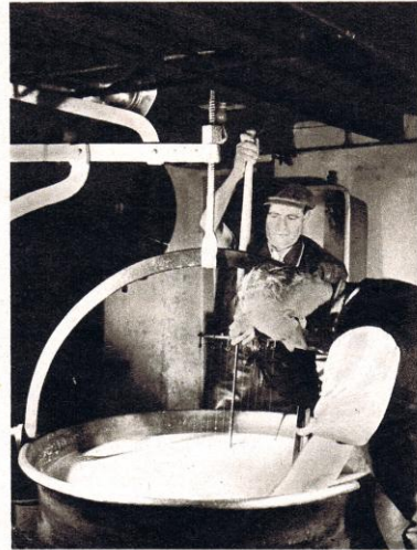
6 La masse blanche est brassée avec un instrument composé de fils de fer tendus sur un cadre.
